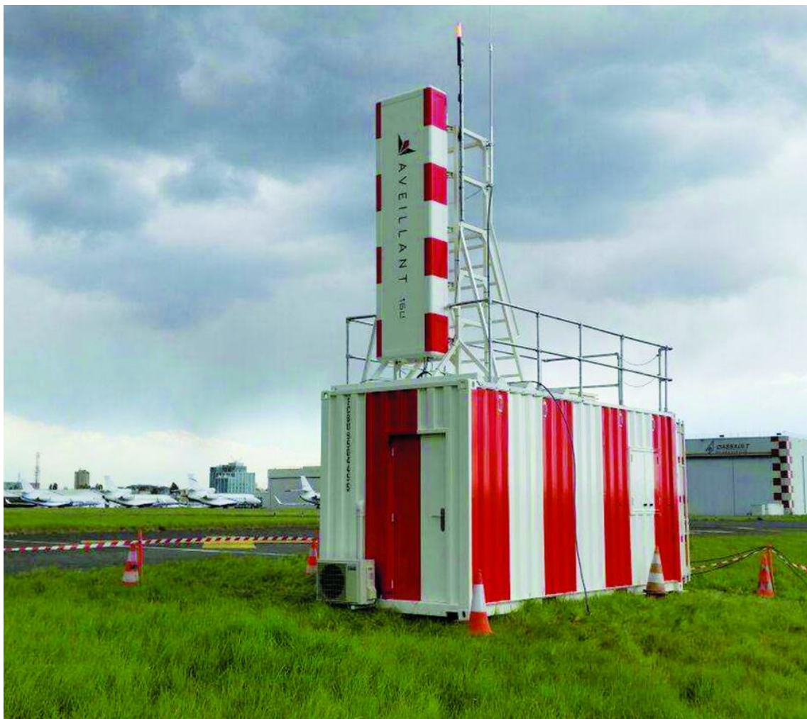
Radars holographiques du dispositif Hologarde.
